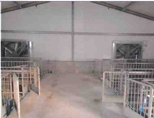
Salle de gavage et aménagements intérieurs (box sur caillebotis avec fosse bétonnée de récupération des déjections)
